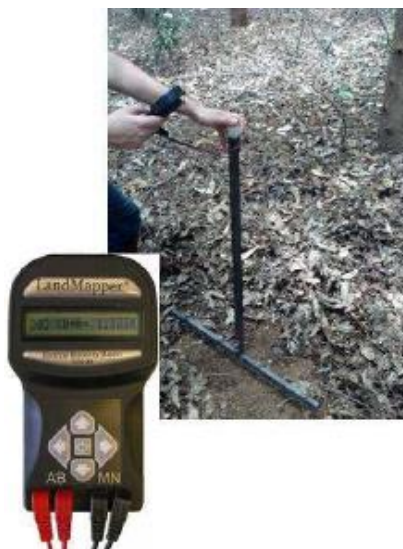
FIGURA 5. Medidor portátil de condutividade elétrica aparente (Landmapper), utilizado no mapeamento da variabilidade espacial do solo.
