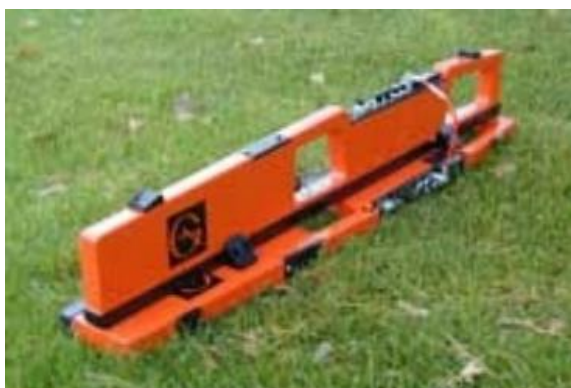
FIGURA 3. Sistema de medida de condutividade elétrica do solo por indução eletromagnética, modelo EM-38.
