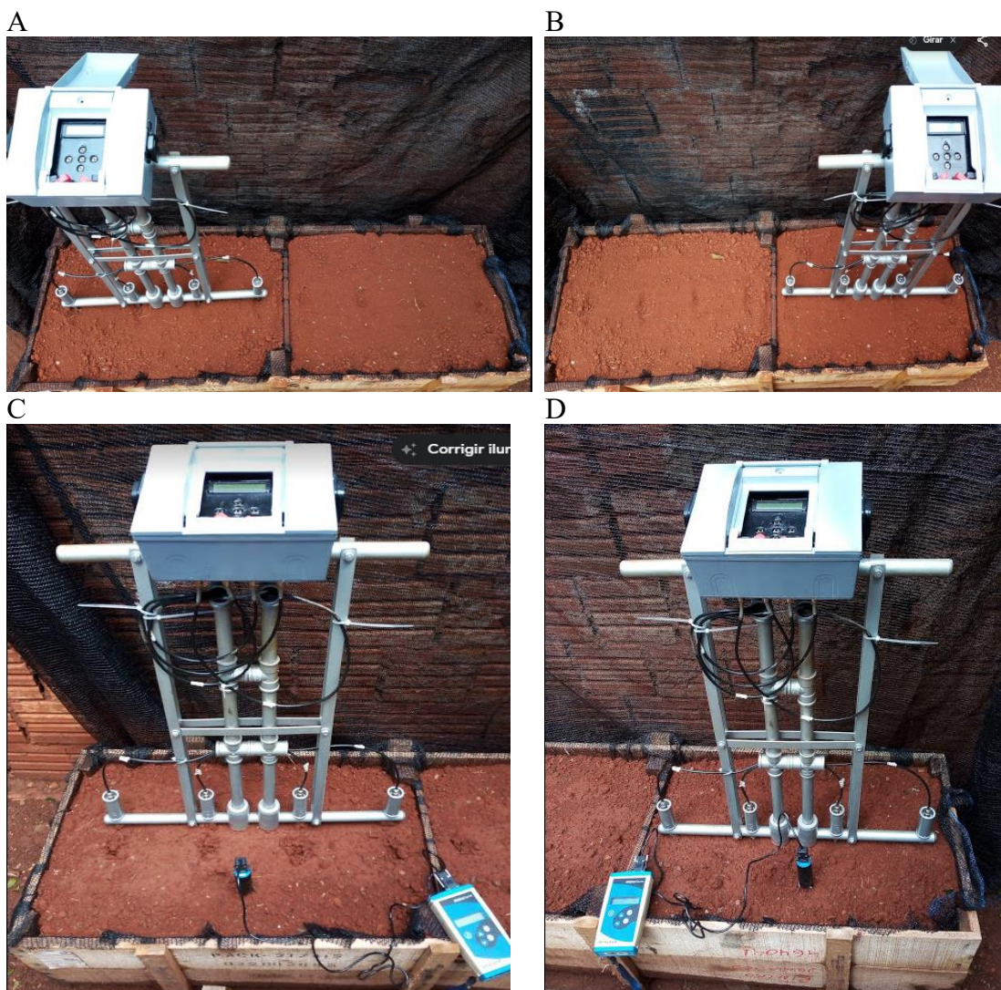
FIGURA 20. Medidor MCEAS realizando leituras da CEa em um Latossolo Vermelho Distroférico depositado na caixa de madeira (A: lado esquerdo; B: lado direito), com determinador de umidade (C, D).
